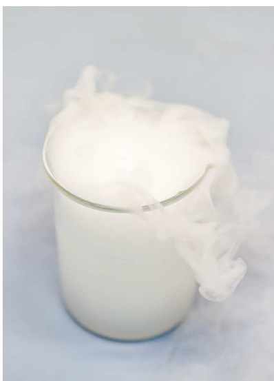
Po wrzuceniu suchego lodu do roztworu wodorotlenku wapnia część tlenku węgla(IV) ulega sublimacji, część przechodzi do roztworu, reagując z jego składnikami.
