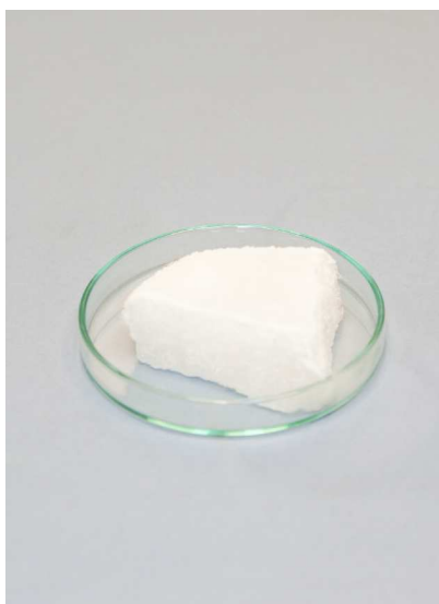
Suchy lód to dwutlenek węgla – tlenek węgla(IV) – w stanie stałym.
