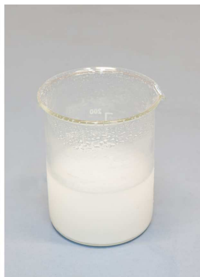
Po pewnym czasie w wyniku reakcji wodorotlenku wapnia z tlenkiem węgla(IV) powstaje trudno rozpuszczalny w wodzie węglan wapnia.
