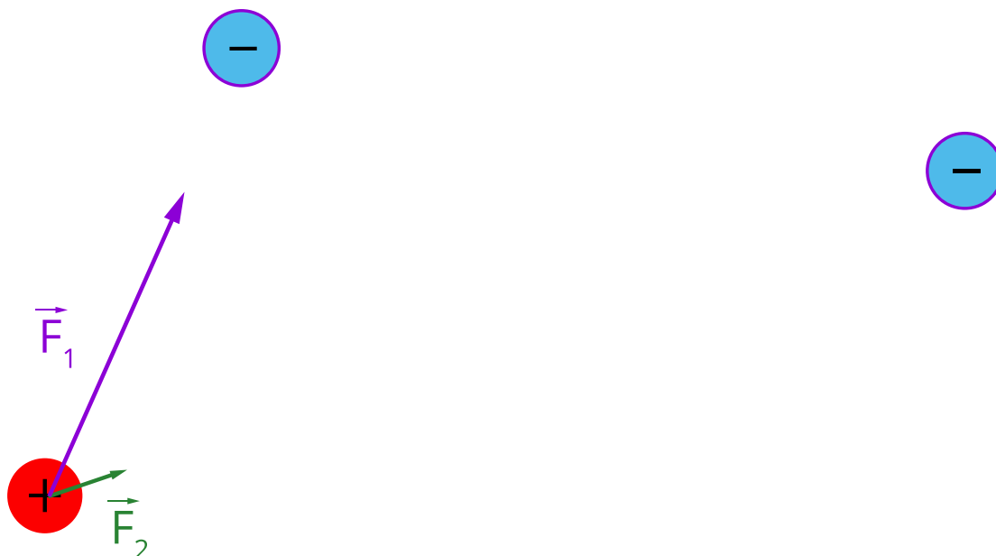
Rys. 8. Ładunki oddziałujące elektrostatycznie. Odległości jon-elektron mają się do siebie jak 1:2, zatem siły różnią się wartościami 4-krotnie
