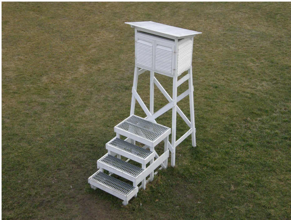
Klatka meteorologiczna zabezpiecza przyrządy służące do pomiarów meteorologicznych – termometry i higrometry – przed bezpośrednim działaniem promieni słonecznych
