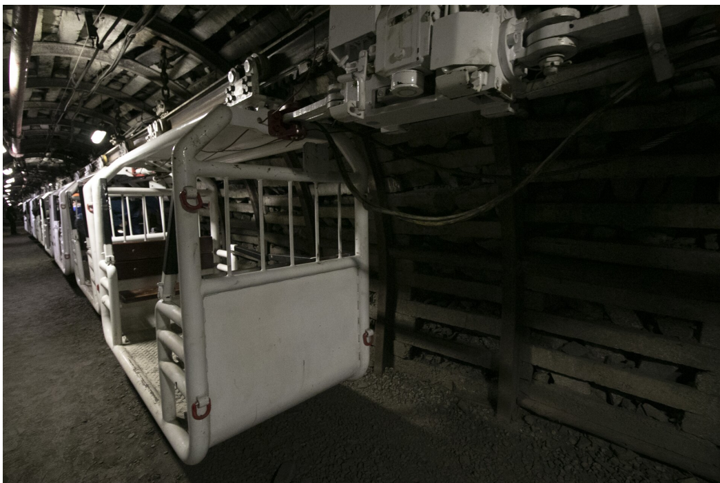
Wagoniki kolei podziemnej, służące do przewozu ludzi
