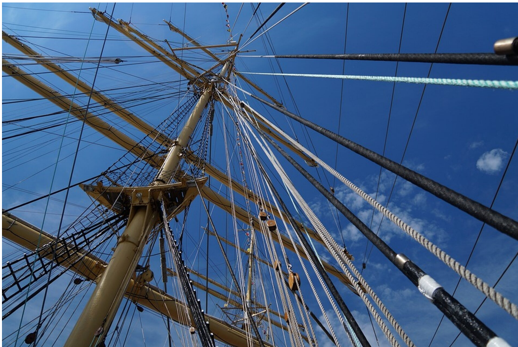
Rys. a. Liny i maszt – przykład układu wielu sił.
