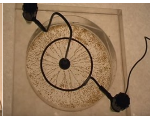
Rys. 8. Eksperyment dla dwóch naładowanych różnoimiennie przewodników: kolistych (a), płaskich ułożonych równoległe (b) oraz kolistych ułożonych tak, że ich środki się pokrywają (c)
