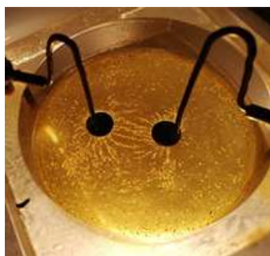
Rys. 8. Eksperyment dla dwóch naładowanych różnoimiennie przewodników: kolistych (a), płaskich ułożonych równoległe (b) oraz kolistych ułożonych tak, że ich środki się pokrywają (c)
