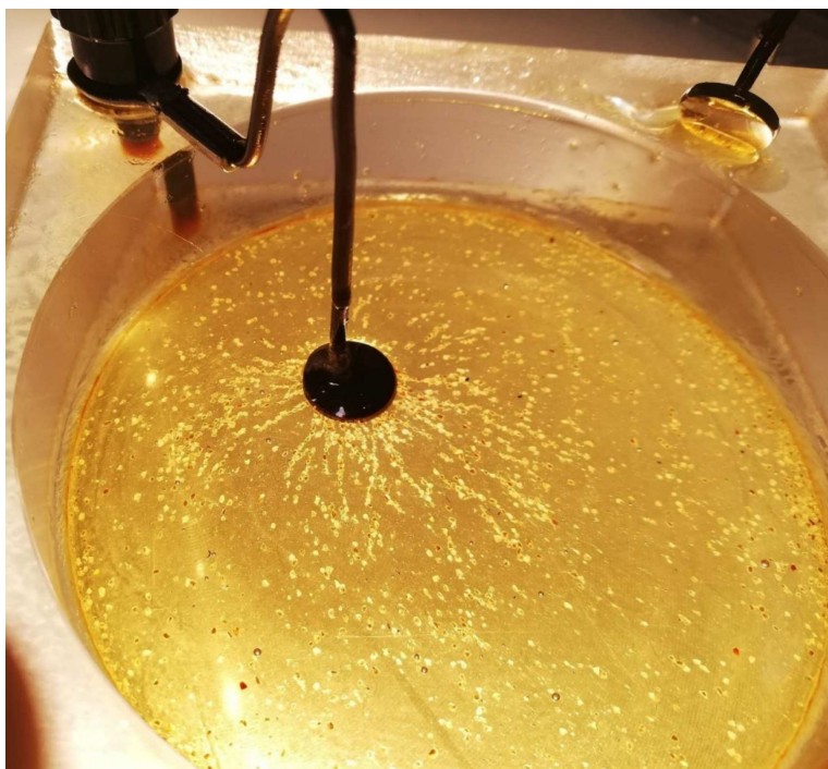
Rys. 7. Demonstracja linii pola elektrycznego z pomocą pojedynczej elektrody
