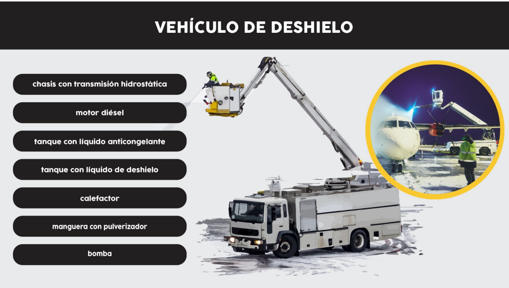
El gráfico presenta un vehículo de deshielo para aeronaves.
