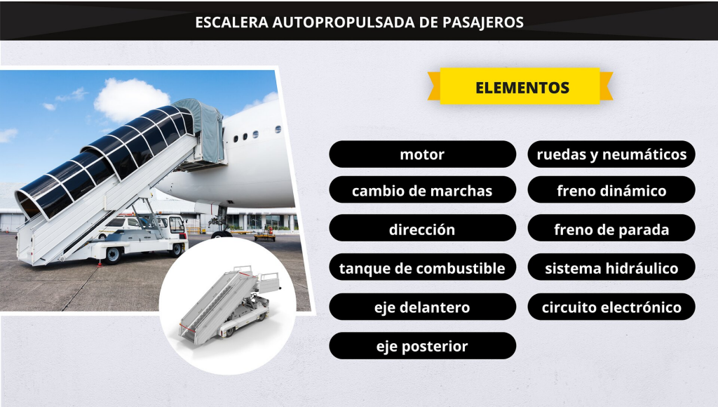
El gráfico presenta una escalera autopropulsada de pasajeros y detalla sus elementos.
