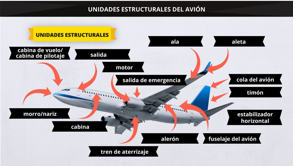
El gráfico presenta las principales unidades estructurales del avión.
