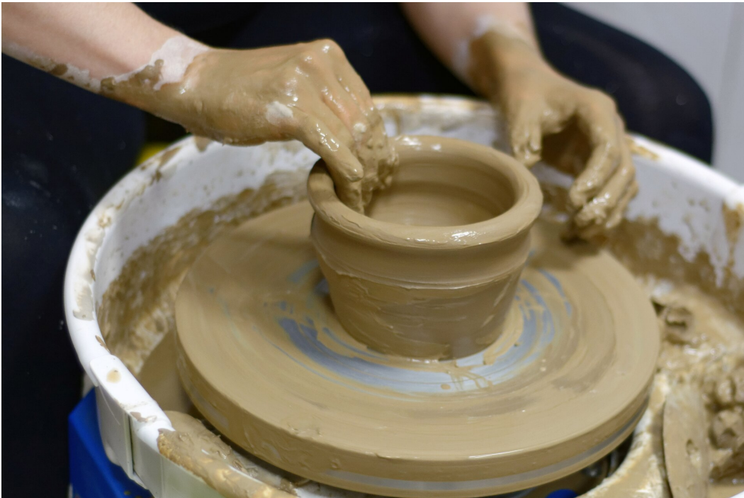
Rys. a. Wykonywanie glinianego naczynia na kole obrotowym.
