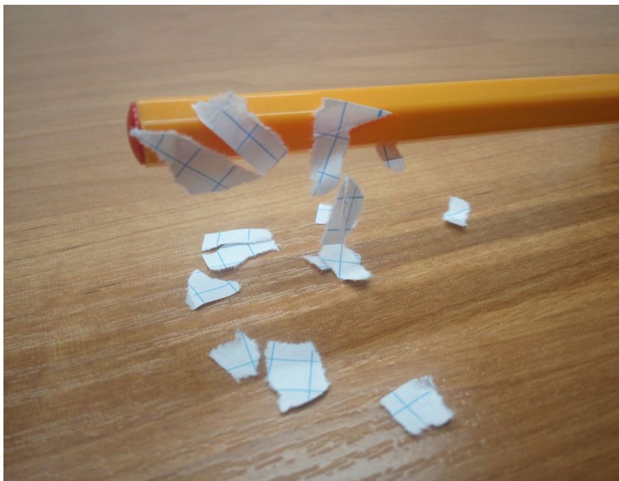
Rys. 4. Długopis, naelektryzowany przez pocieranie, elektryzuje przez indukcję skrawki papieru i zaczyna je przyciągać
