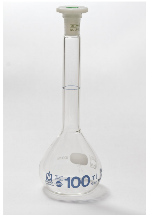
Kolba miarowa o objętości 100 cm 3 Źródło: Lucasbosch, dostępny w internecie: https://pl.wikipedia.org/ , licencja: CC BY-SA 3.0.
