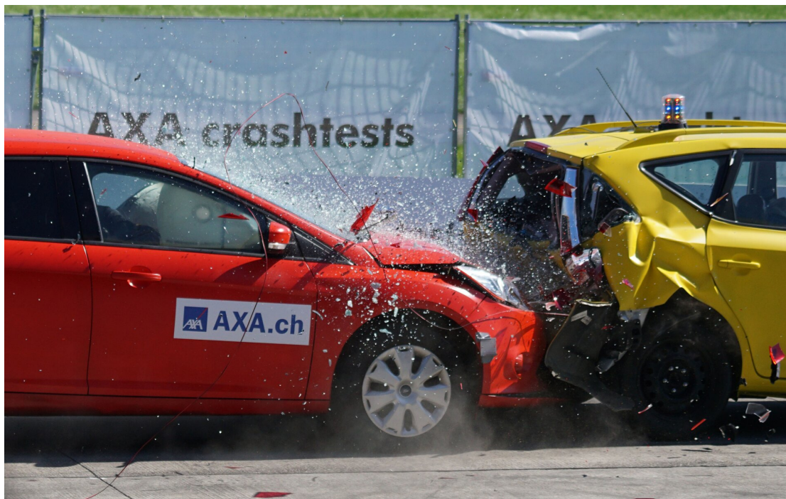
Rys. 2. Wypadek samochodowy jest przykładem zderzenia niesprężystego. Duża część początkowej energii kinetycznej pojazdów jest zamieniana na pracę odkształcenia karoserii i energię cieplną.
