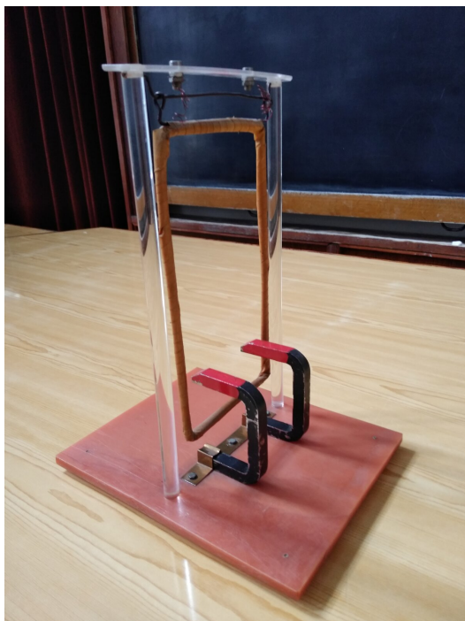
Rys. a. Ramka z prądem wytwarza pole magnetyczne i zachowuje się jak magnes.
