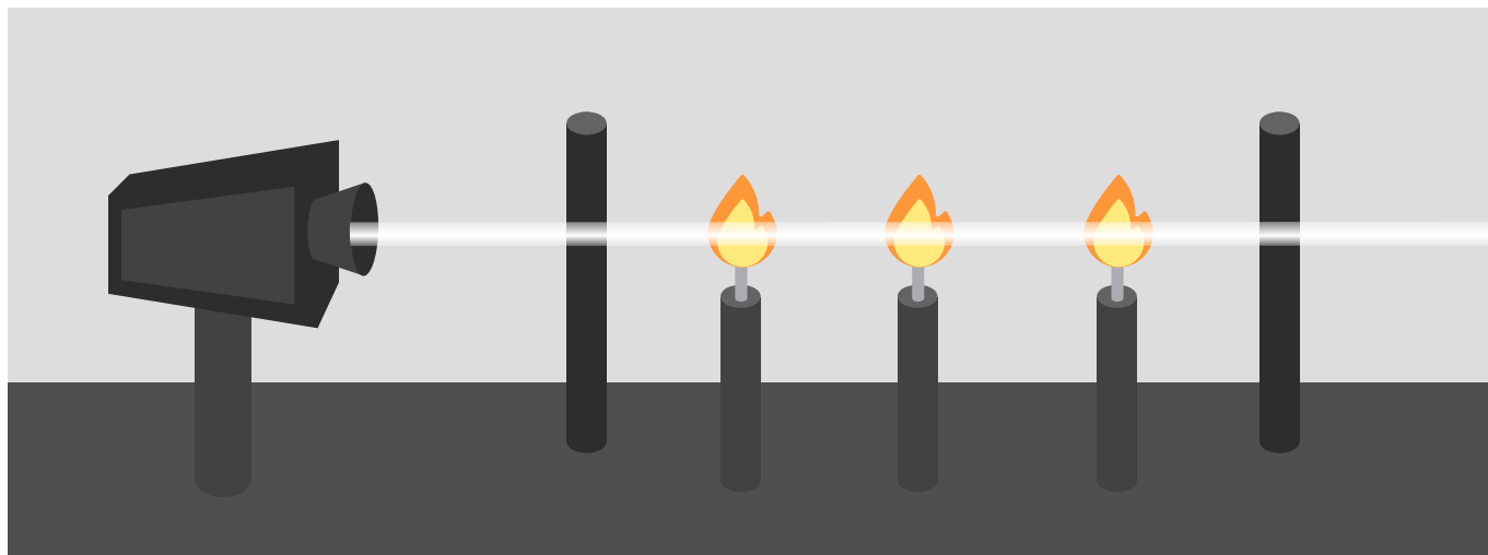
Rys. 2. Uproszczony schemat doświadczenia, w którym obserwujemy widmo absorpcyjne sodu.
