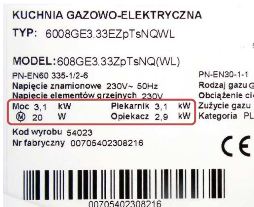
Rys. 2. Przykład danych na tabliczce znamionowej, dotyczących mocy urządzenia i jego poszczególnych elementów (piekarnika, opiekacza i silnika napędzającego opiekacz).
