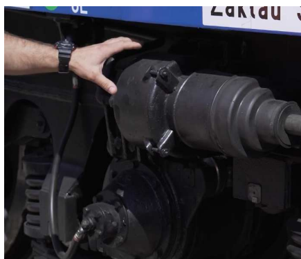
Demontaż cylindrów hamulcowych
