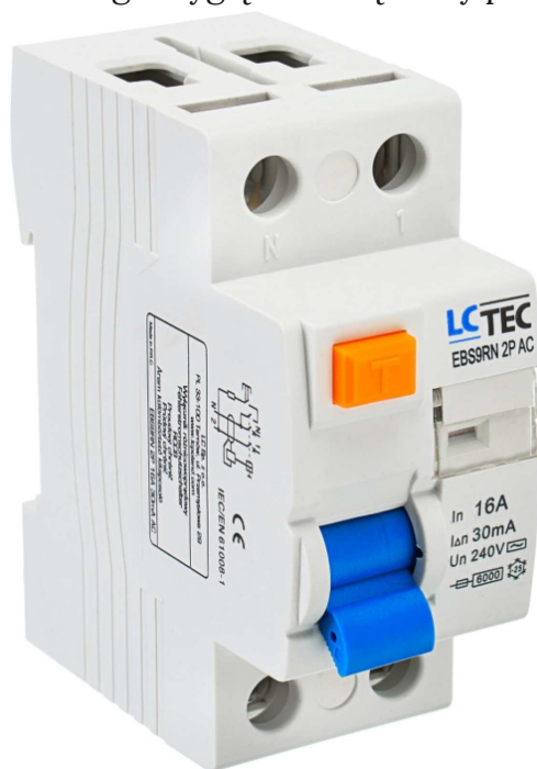
Rys. 1. Wyłącznik różnicowoprądowy. Reaguje na różnicę prądu wpływającego i wypływającego o wartości powyżej 30 mA.
