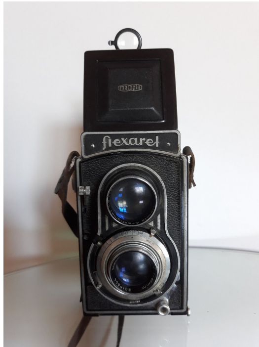
Rys. a. Dwuobiektywowy, analogowy aparat fotograficzny, produkowany w latach 1939 - 1970 w Czechosłowacji
