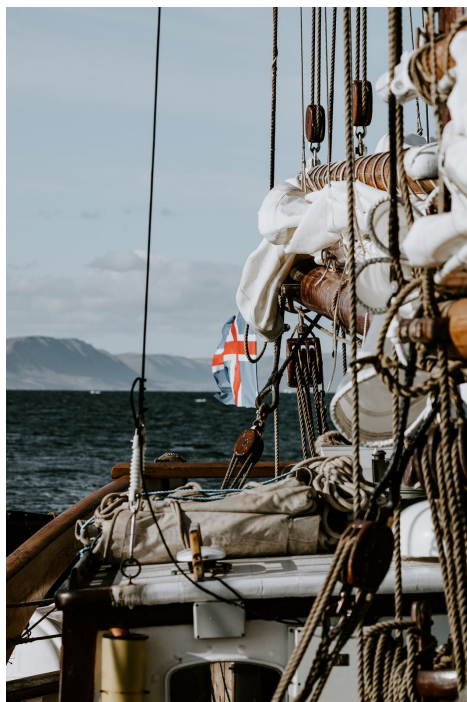
Rys. a. Fragment olinowania żaglowca z widocznymi wielokrążkami
