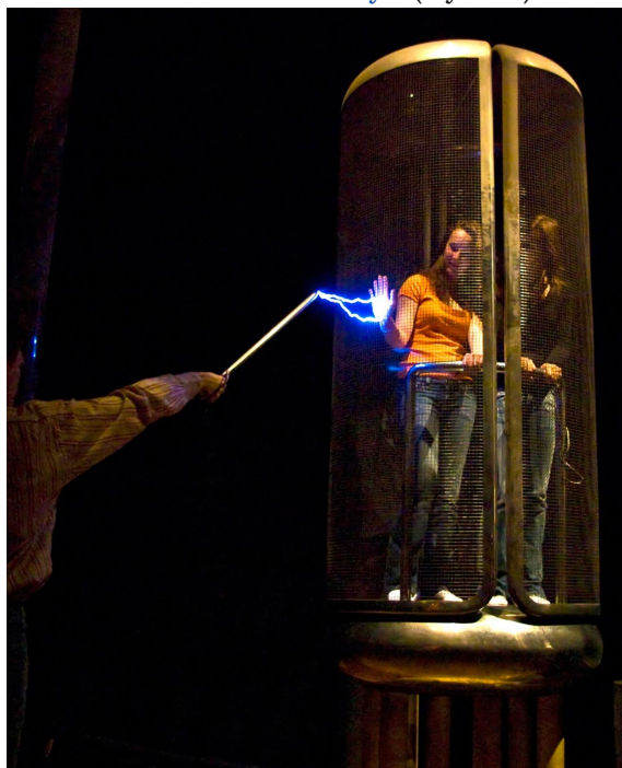
Rys. 2. Demonstracja klatki Faradaya na ochotnikach w Palais de la Découverte w Paryżu
