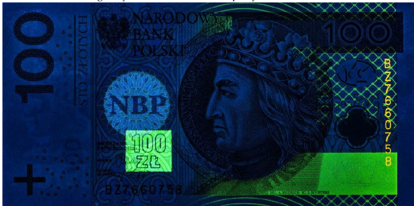
Rys. 2. Na banknocie oświetlonym promieniowaniem UV ujawniają się elementy niewidoczne w świetle widzialnym.
