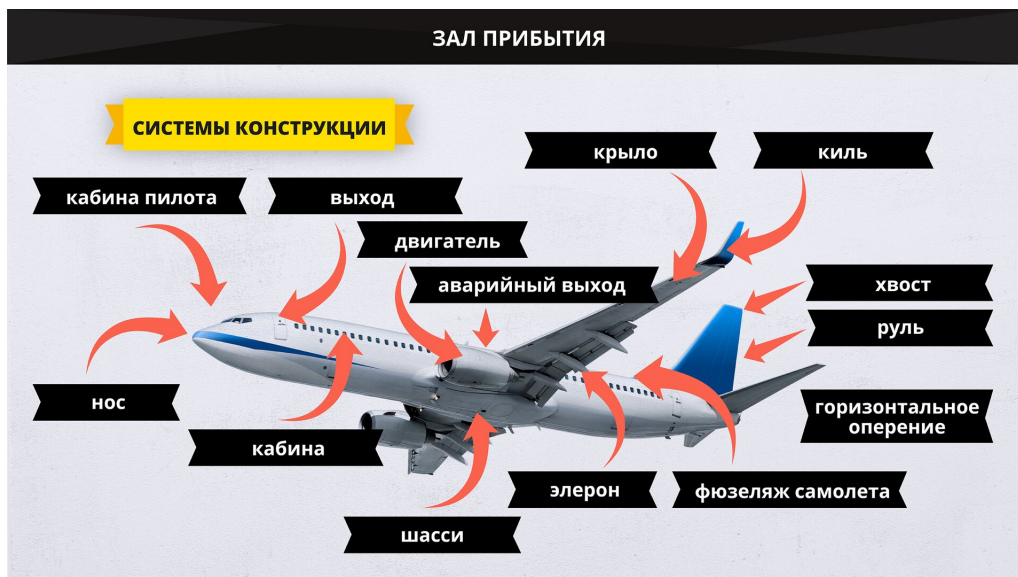
На изображении представлены элементы конструкции самолета.
