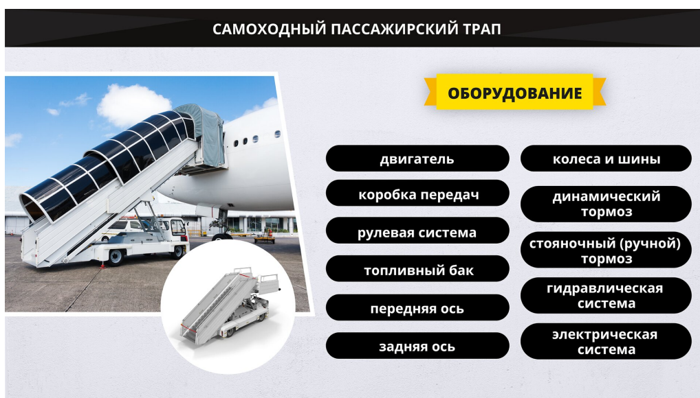
На изображении представлен самоходный пассажирский трап и выделены его элементы.
