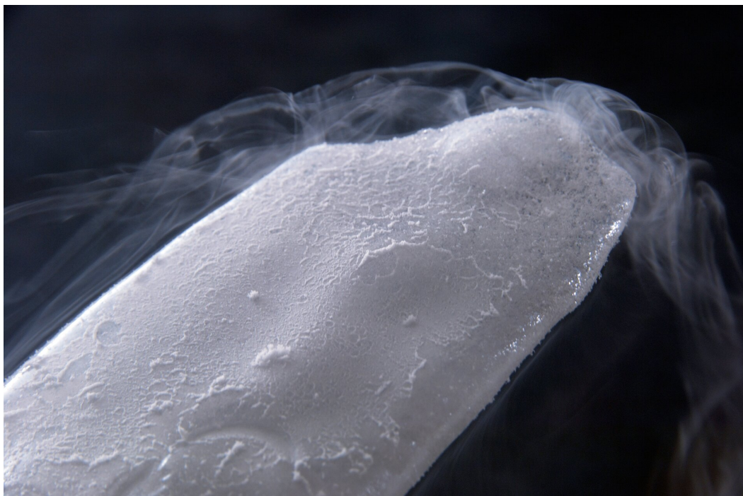
Fot. a. Sublimacja zestalonego dwutlenku węgla (tzw. suchego lodu). Mgiełka ("opary") widoczne na zdjęciu to - kondensująca na zimnym (gazowym) \text{CO}_2 - woda z powietrza
