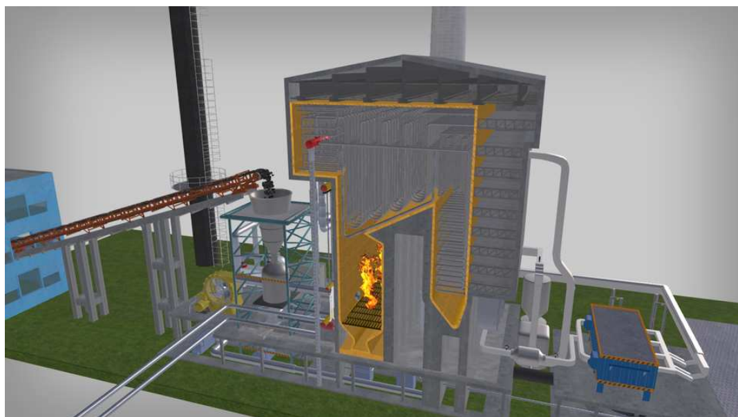
Rys. 72 - Układ obiegowy wody w kotle
