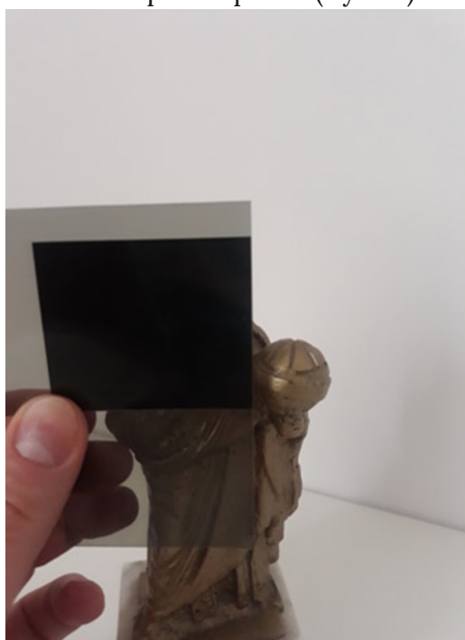
Rys. 8. Prostopadłe ustawienie dwóch polaryzatorów powoduje wygaszenie fali świetlnej.
