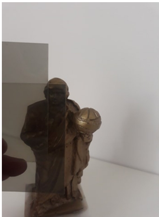
Rys. 7. W przypadku równoległego ułożenia polaryzatorów, światło spolaryzowane przez pierwszy polaryzator przechodzi w całości przez drugi z polaryzatorów
