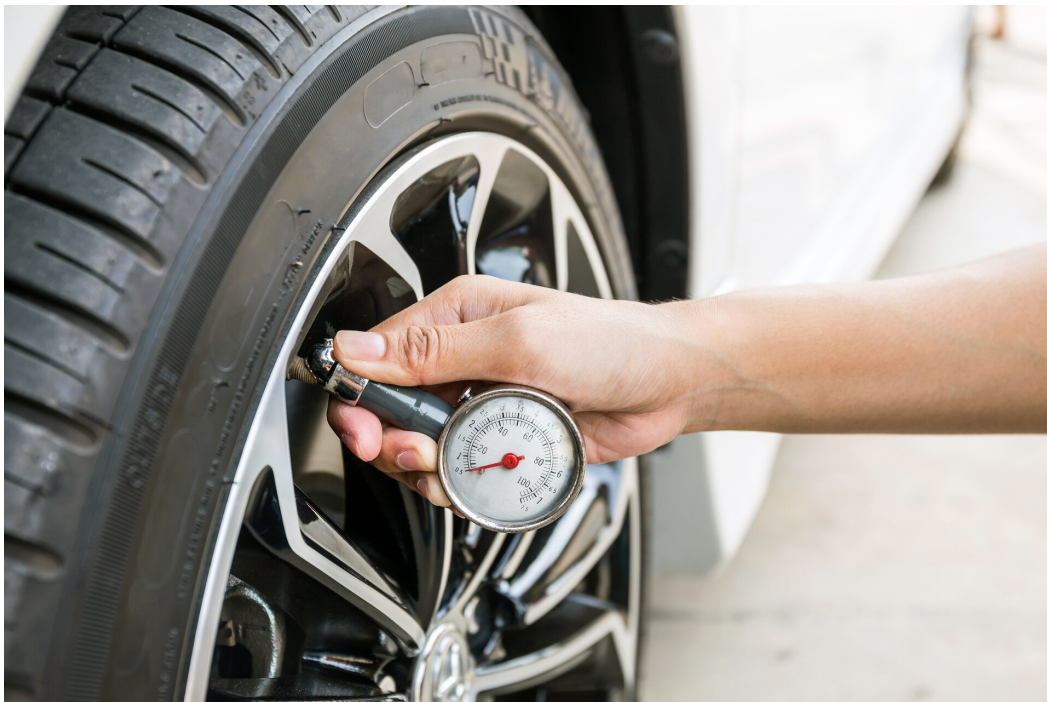
Fot. a. Sprawdzanie ciśnienia w oponie z pomocą manometru
