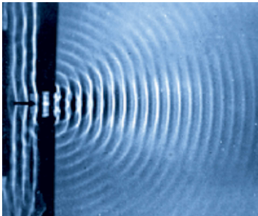
Rys. 2. Dyfrakcja fali na powierzchni wody po przejściu przez szczelinę o szerokości rzędu trzech długości fali Źródło: tylko do użytku edukacyjnego na zpe.gov.pl .
