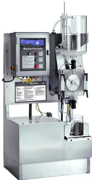
Fot. 6. Urządzenie służące do oceny zawartości zanieczyszczeń w masie celulozowej. Masa filtrowana jest przez precyzyjne sita 75, 100 lub 150 mikrometrów. Spełniane normy: TAPPI T274.
