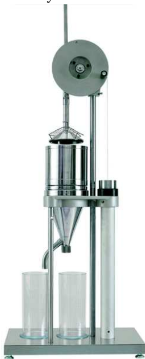
Fot. 3. Urządzenie do oznaczania stopnia zmielenia metodą Schoppera-Rieglera (PN-EN ISO 5267-1:2002)
