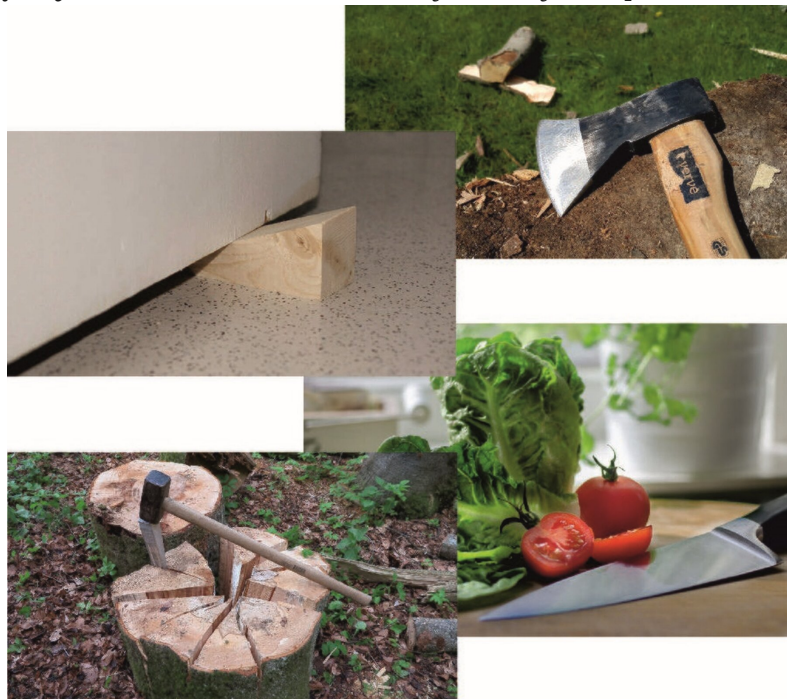
Rys. 3. Przykłady klinów: ostrze siekiery lub noża, klin do łupania drewna, klin blokujący drzwi.
