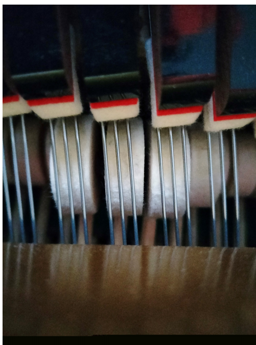
Niesymetrycznie poukładane struny potrójnych chórów
