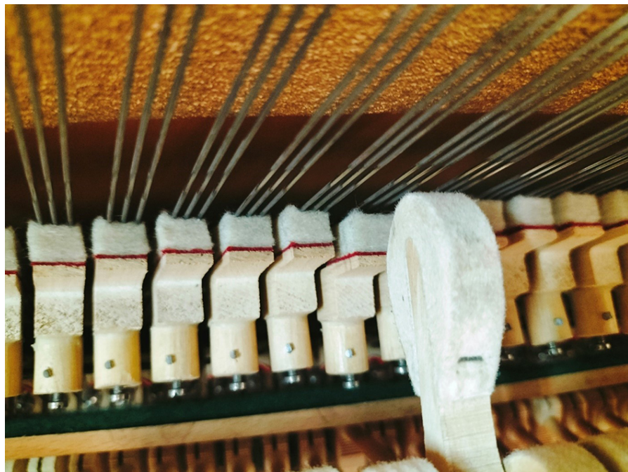
Zbyt późne oddalanie się dźwigni tłumika od struny
