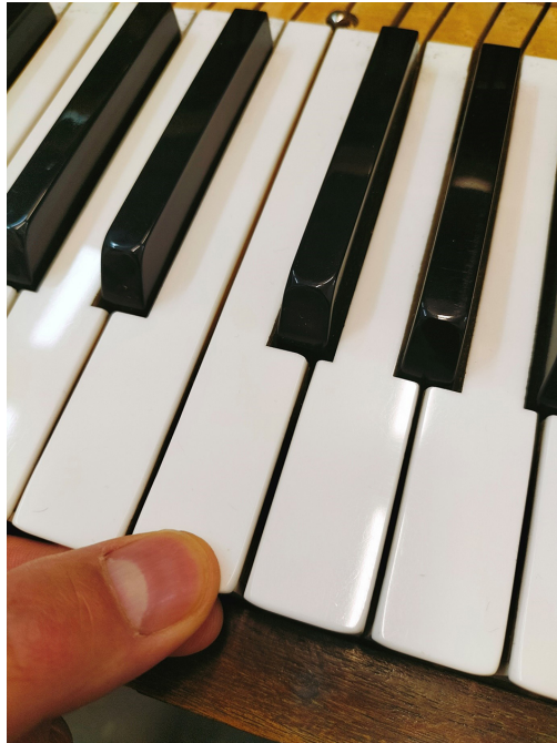
Luzy boczne na łożyskach kaszmirowych klawiatury
