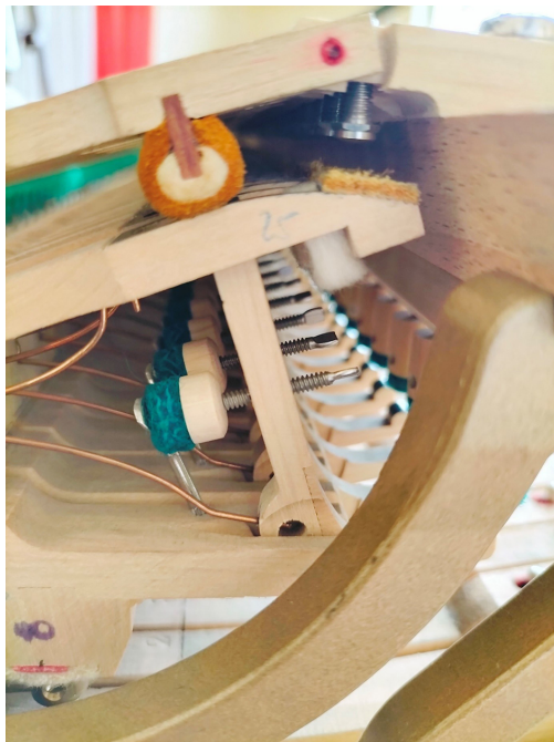
Źle wyregulowane popychacze dźwigni głównej mechanizmu
