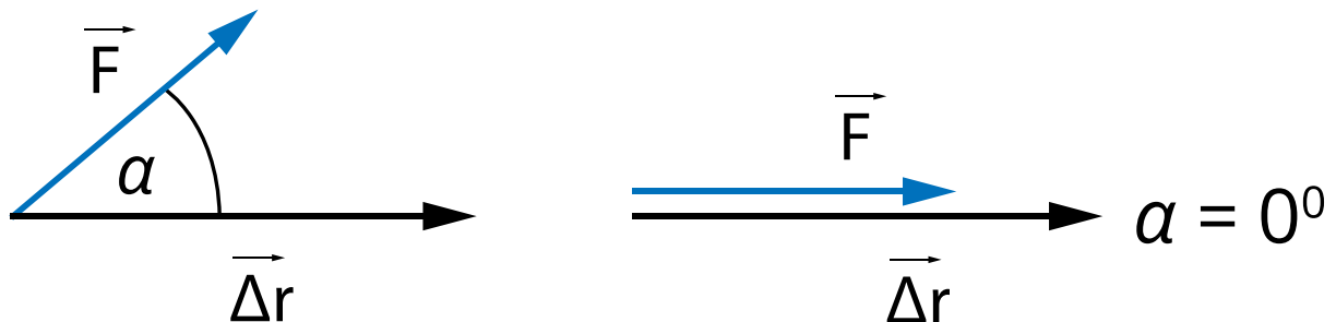
Rys. 1. Przykłady sił wykonujących dodatnią pracę, która zwiększa energię układu. Kąt między wektorem siły i wektorem przesunięcia: \alpha \in (0^\circ - 90^\circ)
