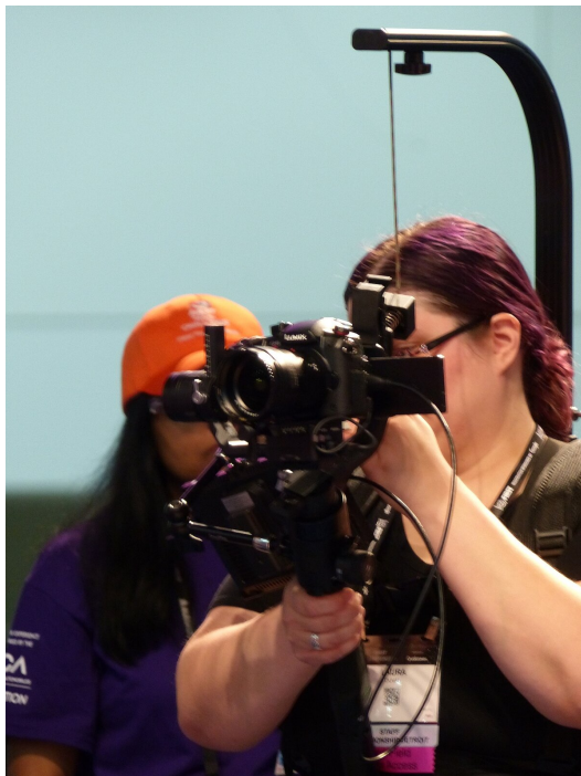
Rys. 2e. Stabilizator obrazu jako przykład urządzenia wykorzystującego zasadę zachowania momentu pędu.
