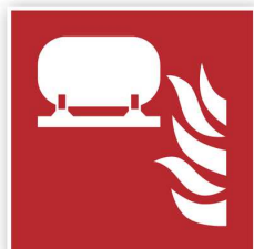
Stała instalacja gaśnicza
