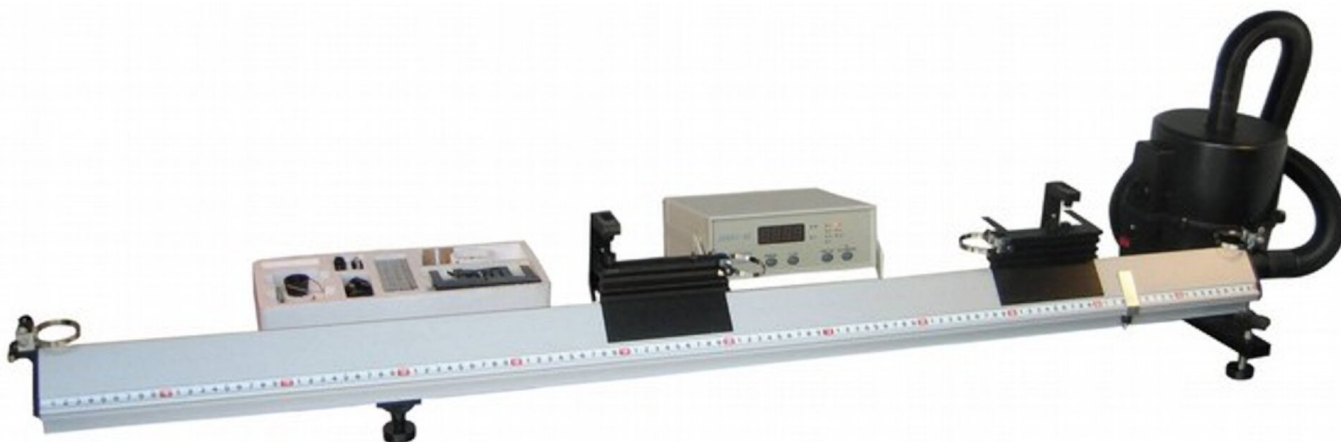
Rys. 3. Tor powietrzny z wózkami do badania zderzeń. Na zdjęciu widać pompę powietrza - dzięki powietrzu wydmuchivanemu przez otwory w torze, wózki mogą ślizgać się po nim prawie bez tarcia.
