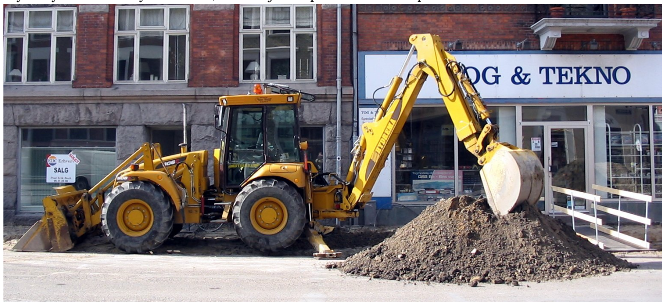
Koparka podsiębierana (backhoe loader).
