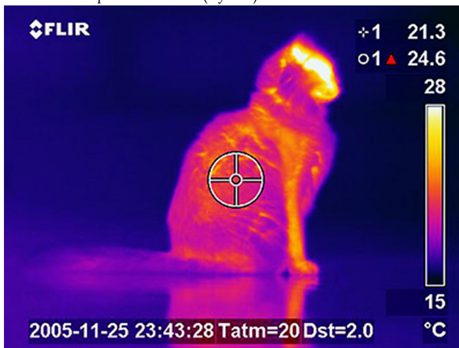
Rys. 6. Obraz z kamery termowizyjnej pokazuje temperaturę obiektów. Barwa biała oznacza najwyższą temperaturę, kolor niebieski – najniższą.
