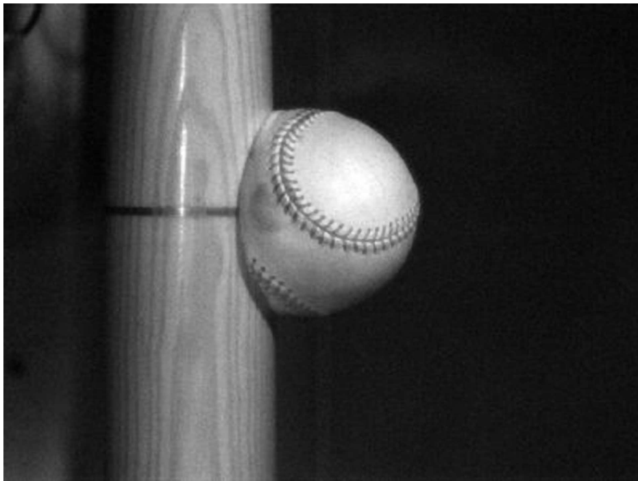
Rys. 2. Piłka bejsbolowa odkształcona w trakcie zderzenia z kijem. Energia kinetyczna piłki w czasie zderzenia zamienia się na energię potencjalną sprężystości i z powrotem na energię kinetyczną.
