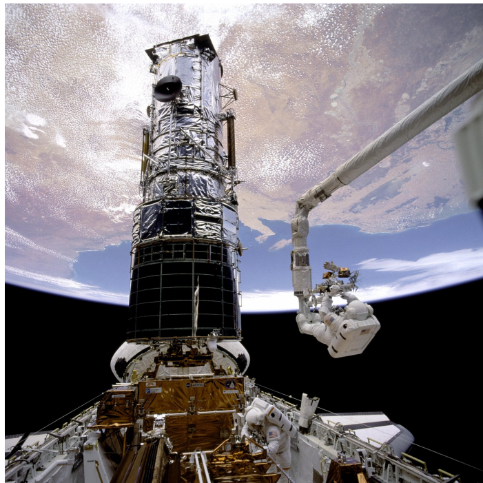
Rys. 1b. Astronauta F. Story Musgrave na wysięgniku przygotowujący się do wyniesienia na szczyt teleskopu HST w celu umieszczenia na nim niezbędnych zasłon na magnetometrze. Poniżej stoi astronauta Jeffrey A. Hoffman w celu asekuracji kolegi.
