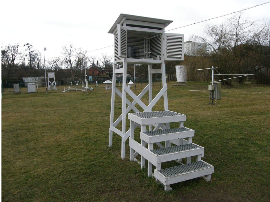
Klatka meteorologiczna w obserwatorium Uniwersytetu Wrocławskiego przy ulicy Kosiby
