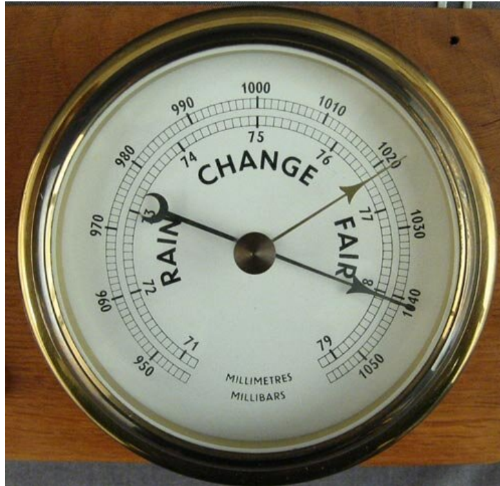
Barometr sprężynowy (aneroid) – przyrząd do pomiaru ciśnienia powietrza
