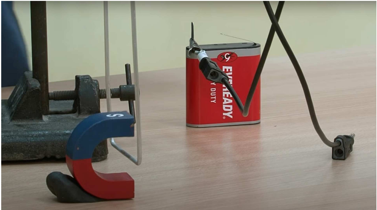
Rys. 3. Wykonana z aluminium huśtawka, którą można wprowadzić w ruch za pomocą siły elektrodynamicznej - opis w tekście.
