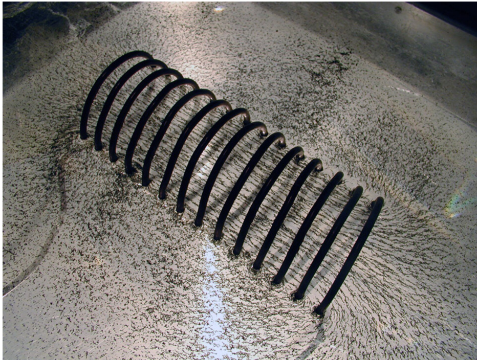
Rys. 6. Obraz pola magnetycznego wokół zwojnicy z prądem uzyskany za pomocą żelaznych opiłków.
