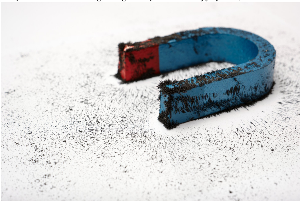
Rys. 3a. Pole magnetyczne w okolicach końcówek magnesu podkowiastego.
