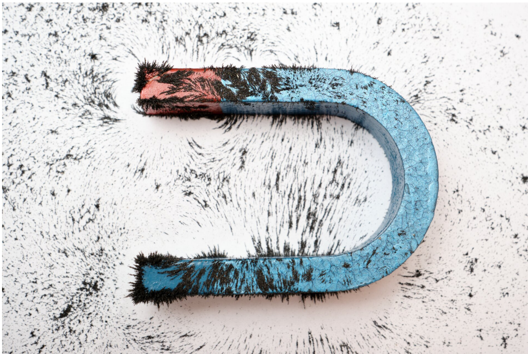
Rys. a. Wzór utworzony przez opiłki żelaza umieszczone w polu magnetycznym.
