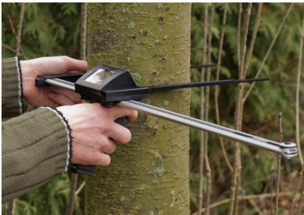
Pomiar pnia drzewa elektroniczną suwmiarką
