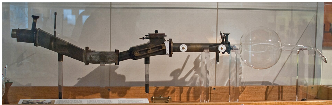
Rys. 2. Replika spektrografu masowego Astona.
