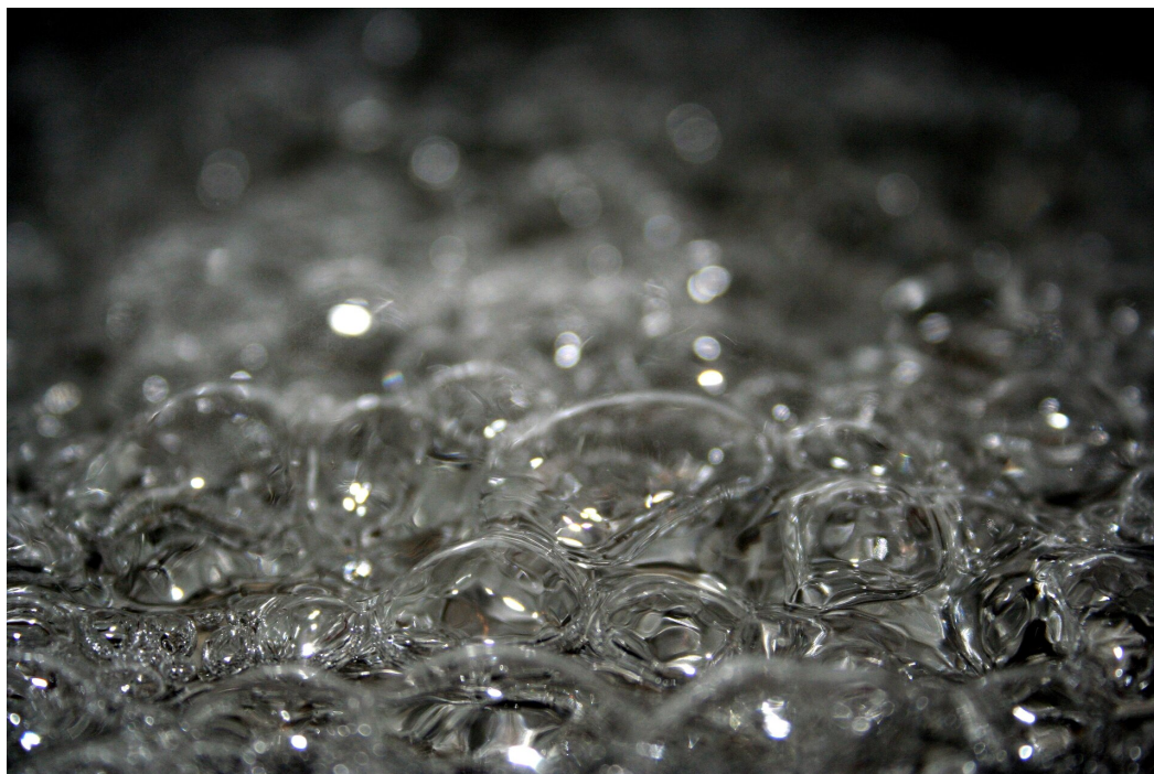
Rys. 2. Wrzenie rozpoczyna się wtedy, gdy ciśnienie pary nasyconej staje się równe ciśnieniu zewnętrznemu.
