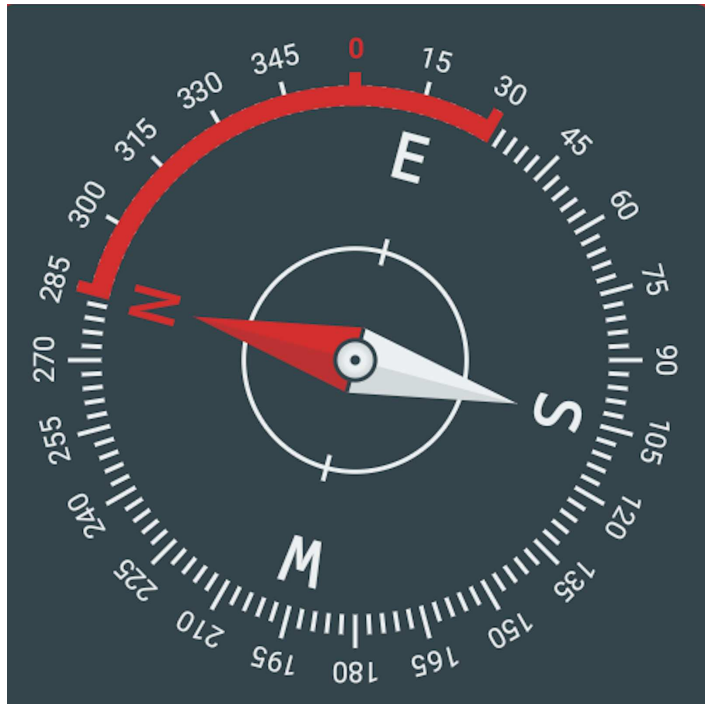
Rys. b. Kompas - aplikacja telefoniczna pochodząca z USA. Zwróć uwagę na odwrotne, niż w Polsce, oznaczenia kolorów biegunów igły magnetycznej.
