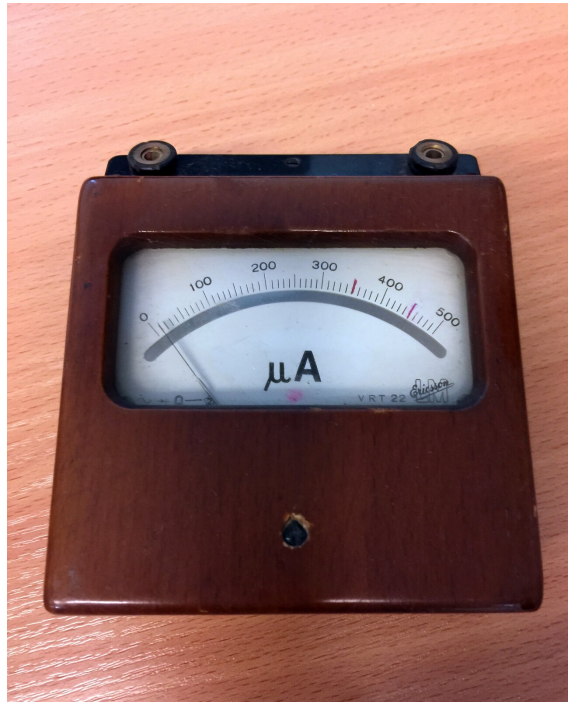
Rys. 1. Mikroamperomierz wskazówkowy z lustrem zamontowanym w celu zmniejszenia błędu paralaksy przy odczycie
