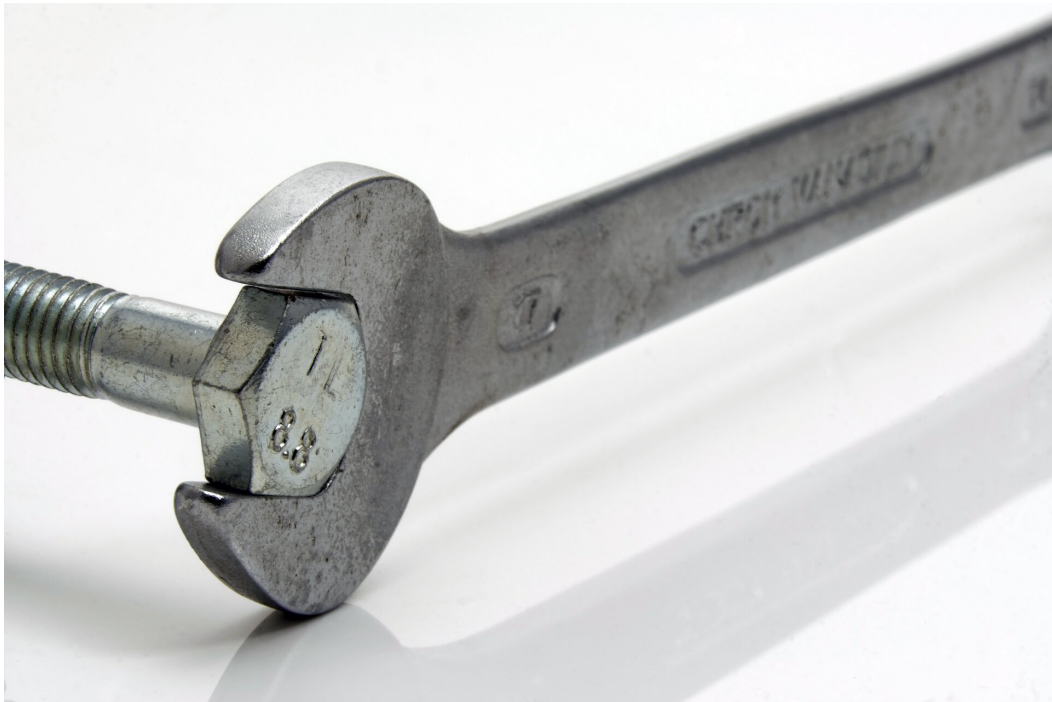
Rys. a. Dokręcanie śruby kluczem to prosty przykład wykorzystania momentu siły.
