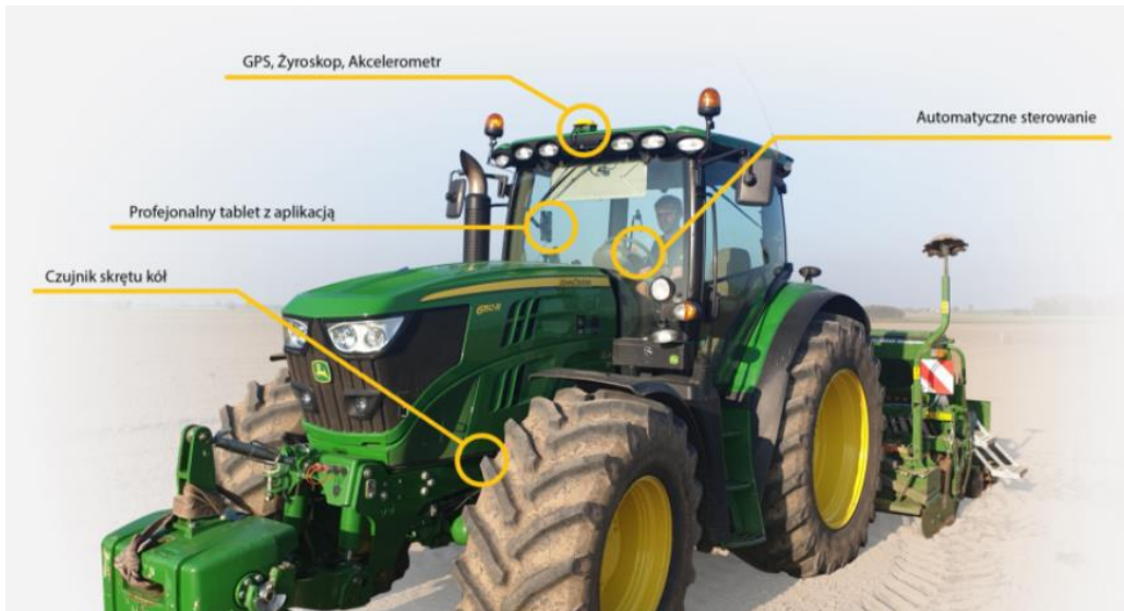
Rysunek 7 Agro OSA - GPS system automatycznego sterowania jazdy równoległej pojazdami rolniczymi z RTK (źródło: agroosa.pl)
