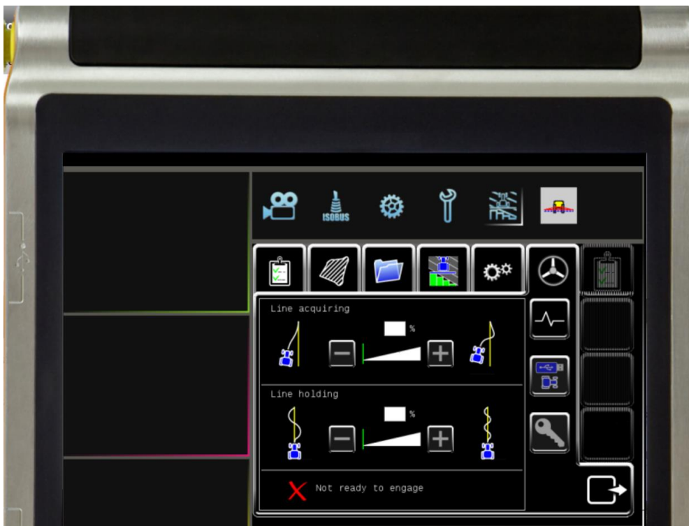
Rysunek 17 Aktywne okno zmiany ustawień sposobu wjazdu w obszar linii referencyjnej przejazdu proponowanej przez system wspomaganie prowadzenia automatycznego. (źródło: Opracowanie własne).
