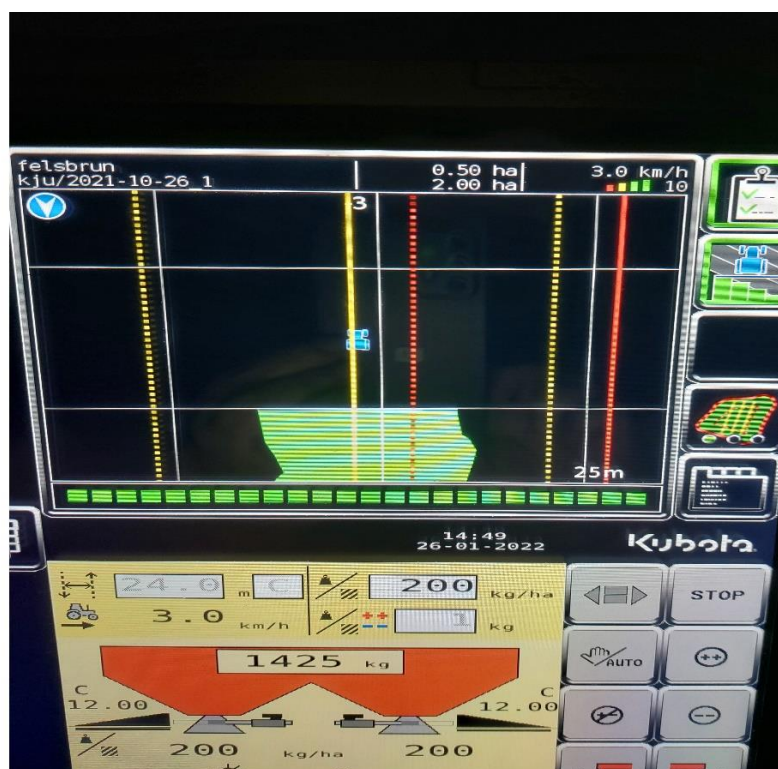
Rysunek 18 Aktywne okno zmiany ustawień i wprowadzania parametrów roboczych maszyny towarzyszącej. (źródło: Opracowanie własne).
