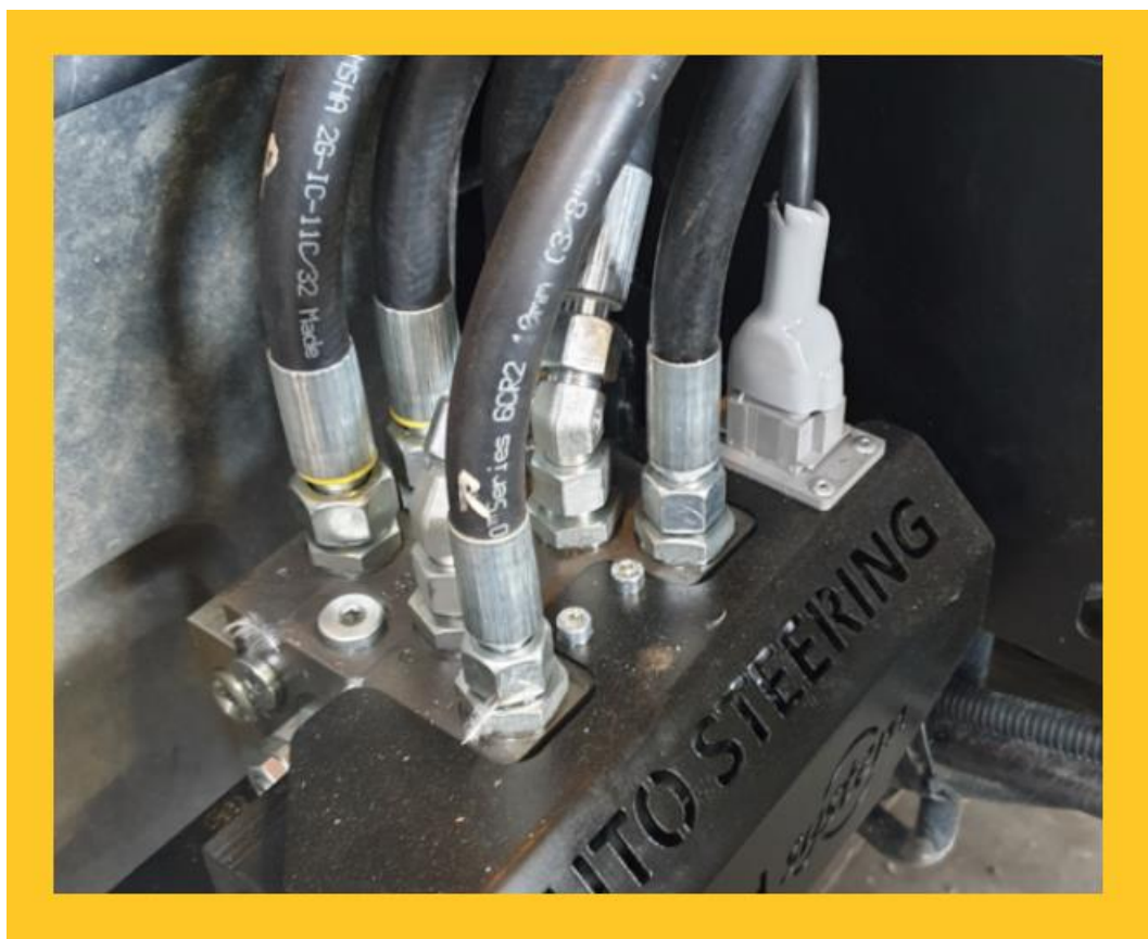
Rysunek 10 Zawór hydrauliczny sterujący pracą układu kierowniczego (źródło: Systemy rolnictwa precyzyjnego CLAAS ACADEMY )
