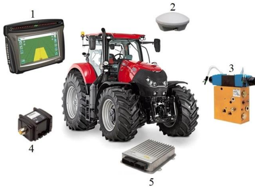
Rysunek 9 Elementy składowe systemów wspomagania kierowania (źródło: Egzamin kwalifikacji w zawodzie M.46-SG-20.06 )
