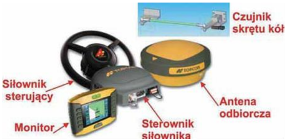
Rysunek 8 Elementy składowe systemów wspomagania kierowania (źródło: agroosa.pl)
