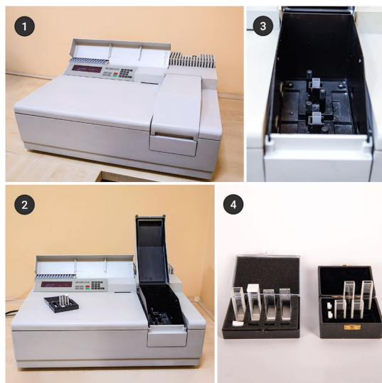
1. Spektrofotometr UV-Vis 2. Spektrofotometr UV-Vis z otwartą komorą pomiarową 3. Komora pomiarowa z kuetetami 4. Kuetety kwarcowe – różne rozmiary
