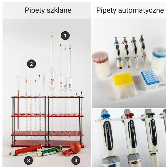
1. Pipety jednomiarowe 2. Pipety wielomiarowe 3. Pompki do pipet 4. Gruszka do pipet
