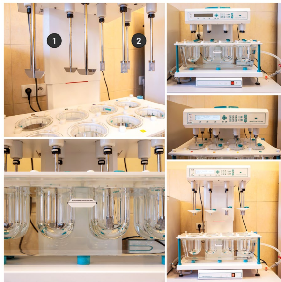
Aparat do badania uwalniania substancji czynnej z postaci leku: 1. łopatkowy 2. koszyzkowy
